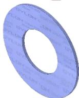
**GYLON® Blue Style 3504:** Guarnizione comprimibile e flessibile con una distribuzione uniforme della carica di microsferi di alluminio-silicato. Perfetta per carichi ridotti e basse coppie di serraggio (ad esempio per flange smaltate e tubi in vetro).
