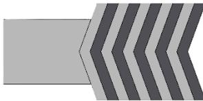
**SWE (Spirometallica con anello esterno di centraggio):** per il miglior posizionamento su accoppiamenti a gradino e per limitare la compressione della guarnizione.
