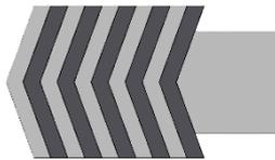
**SWI (Spirometallica con anello interno di contenimento):** inserito all'interno della spirale per aumentare la resistenza meccanica, ideale per accoppiamenti con passaggi di fluido molto turbolenti.
