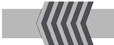
**SWEI (Spirometallica con anelli esterno e interno):** ideale per applicazioni severe, dove si vuole limitare la compressione della guarnizione ed evitare danni da fluido.
